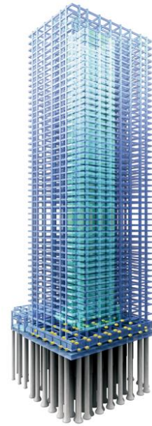
▲免震コアウォールシステム 概念図（クロノレジデンス）
