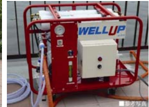
＜(参考)非常用飲料水生成システム＞
