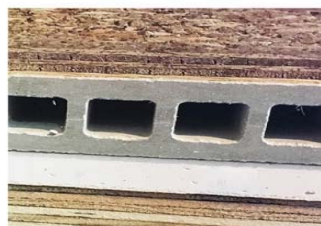
軽量化を図りながら高遮音性能も併中空構造のセメント系パネル
